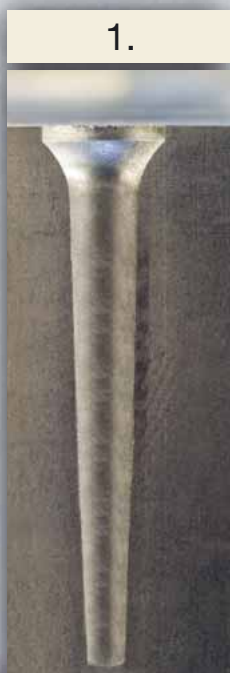
Konisch vorgegossene Bohrung
