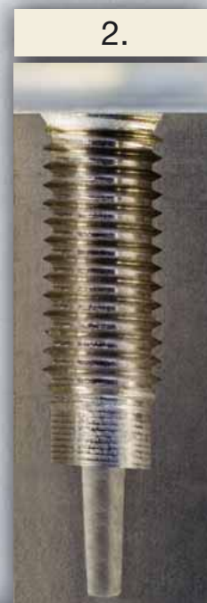
In einem Fertigungsschritt aufgebohrtes und fertig hergestelltes Gewinde
